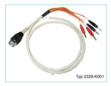
Messkabel 4 polig , 1,5 m langes abgeschirmtes Kabel mit 5-pol. Bajonettstecker und 4 Büschelstecker.
